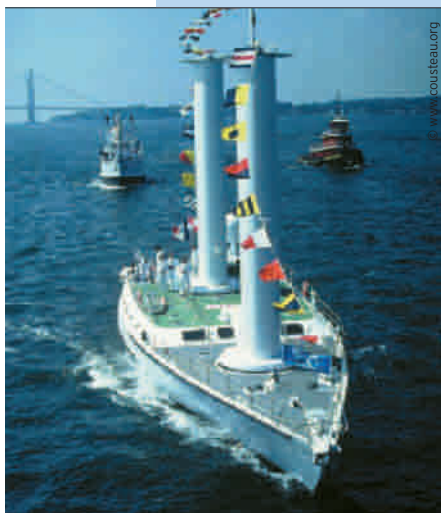
Das Forschungsschiff „Alcyone“ des Meeresforschers Jacques Cousteau ist mit zwei Flettner-Rotoren als Hilfsantrieb ausgerüstet, was 35 Prozent Spritersparnis bringt.
