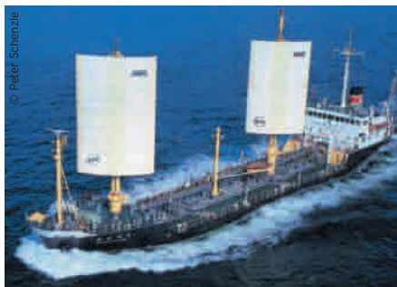
Der japanische Tanker Shin Aitoku Maru hatte starre Profilkörper aus Aluminium als „Segel“, die sich computergesteuert in die jeweils günstigste Position zum Wind drehen ließen. Spritersparnis: 10 bis 30 Prozent.
