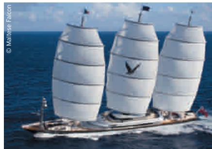
Das Dyna-Rigg mit den zwischen den sechs Rahen aufgespannten Segeln bestimmt das typische und eigenwillige Aussehen der 90-Meter-Yacht „Maltese Falcon“.
